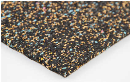
AFM 26 承重範圍：5000 kg/m 2 動態剛性 ≤ 20 MN/m 3 降低衝擊噪聲 ΔL n,w ≥ 26 dB
