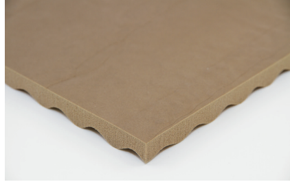
AFM 31 承重範圍：5000 kg/m 2 動態剛性 ≤ 17 MN/m 3 降低衝擊噪聲 ΔL n,w ≥ 31 dB
