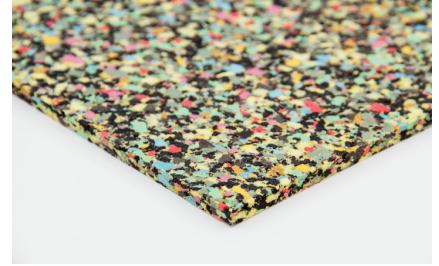
AFM 21 承重範圍：2500 kg/m 2 動態剛性 ≤ 40 MN/m 3 降低衝擊噪聲 ΔL n,w ≥ 21 dB
