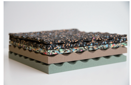
AFM 21 承重範圍：2500 kg/m 2 動態剛性 ≤ 40 MN/m 3 降低衝擊噪聲 ΔL n,w ≥ 21 dB
